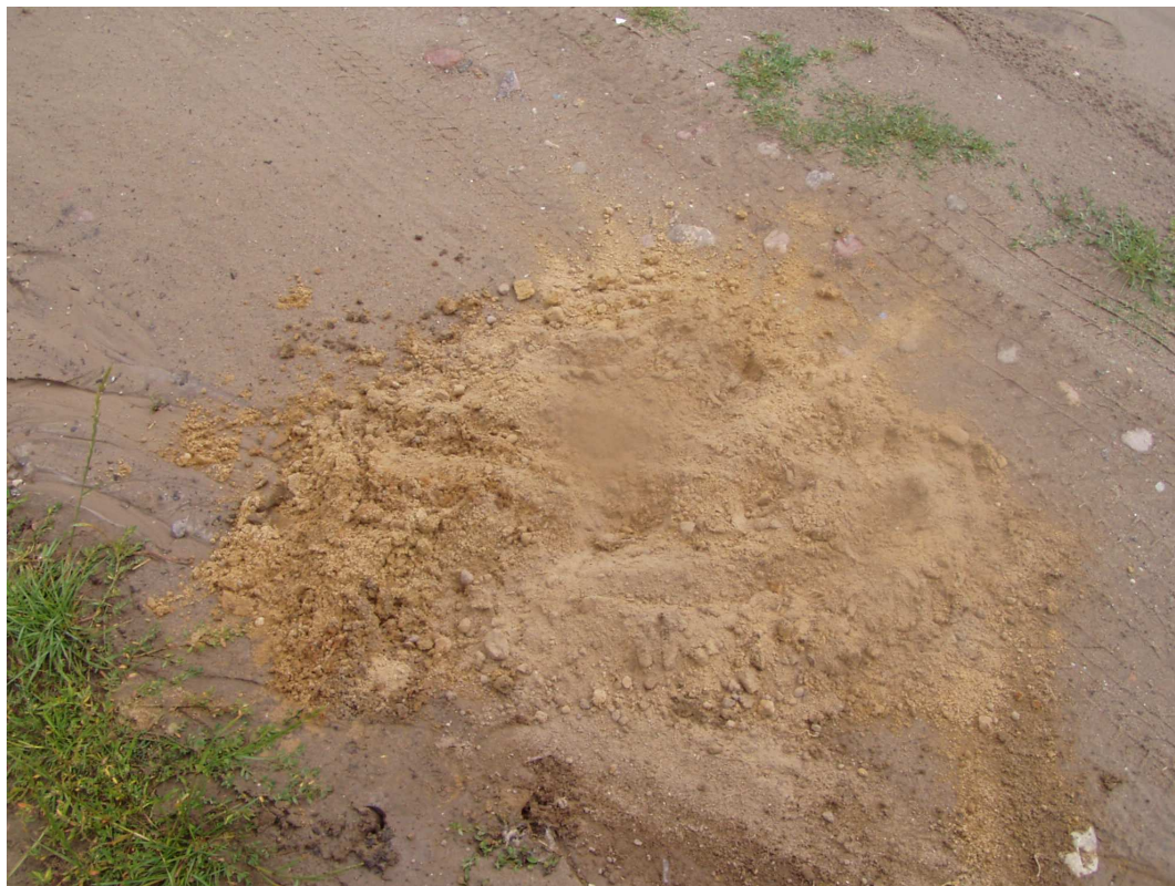
Wykonywanie odwiertów w istniejącej nawierzchni drogi 80cm piasek gruby, 170cm piasek drobny
