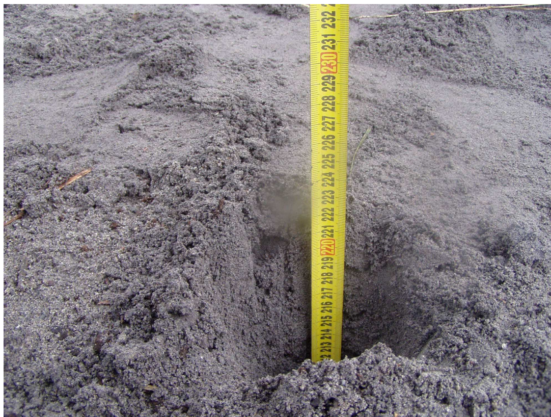
Wykonywanie odwiertów w istniejącej nawierzchni drogi Odwiert nr 4 km 0+800, 220cm ziemia
