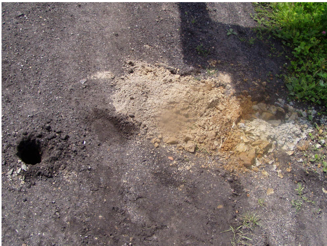
Wykonywanie odwiertów w istniejącej nawierzchni drogi 35cm szlaka/żużel z gruntem rodzimym, piaski
