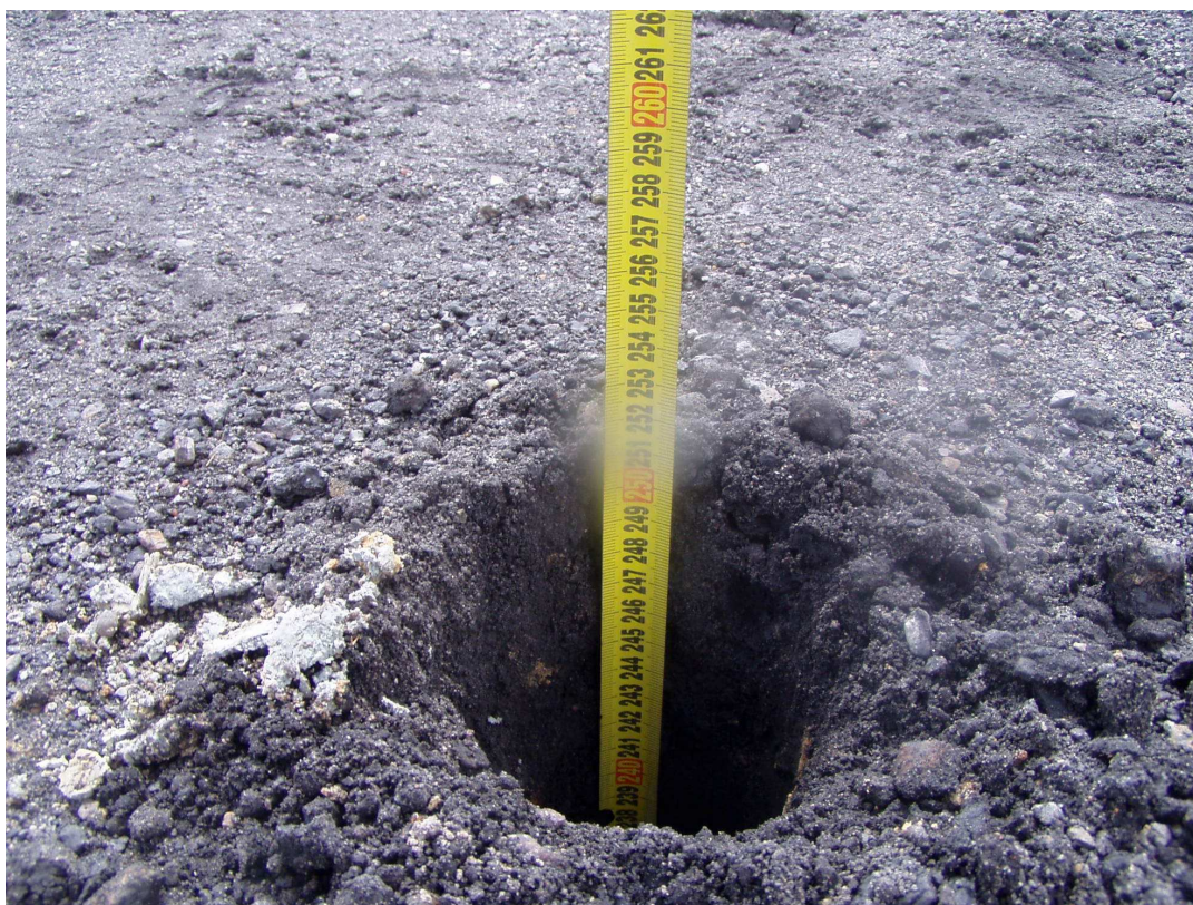
Wykonywanie odwiertów w istniejącej nawierzchni drogi Odwiert nr 1 km 1+300
