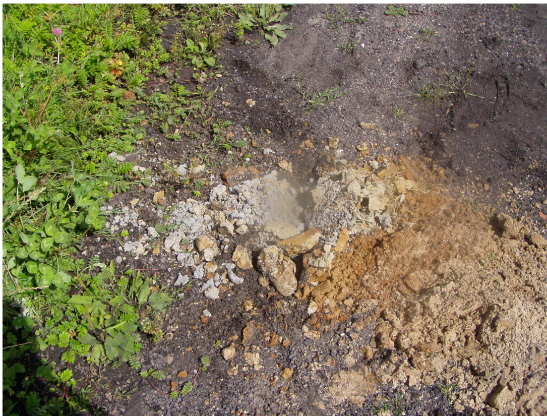
Wykonywanie odwiertów w istniejącej nawierzchni drogi 25cm piasek żółty, 135cm piaski gliniaste
