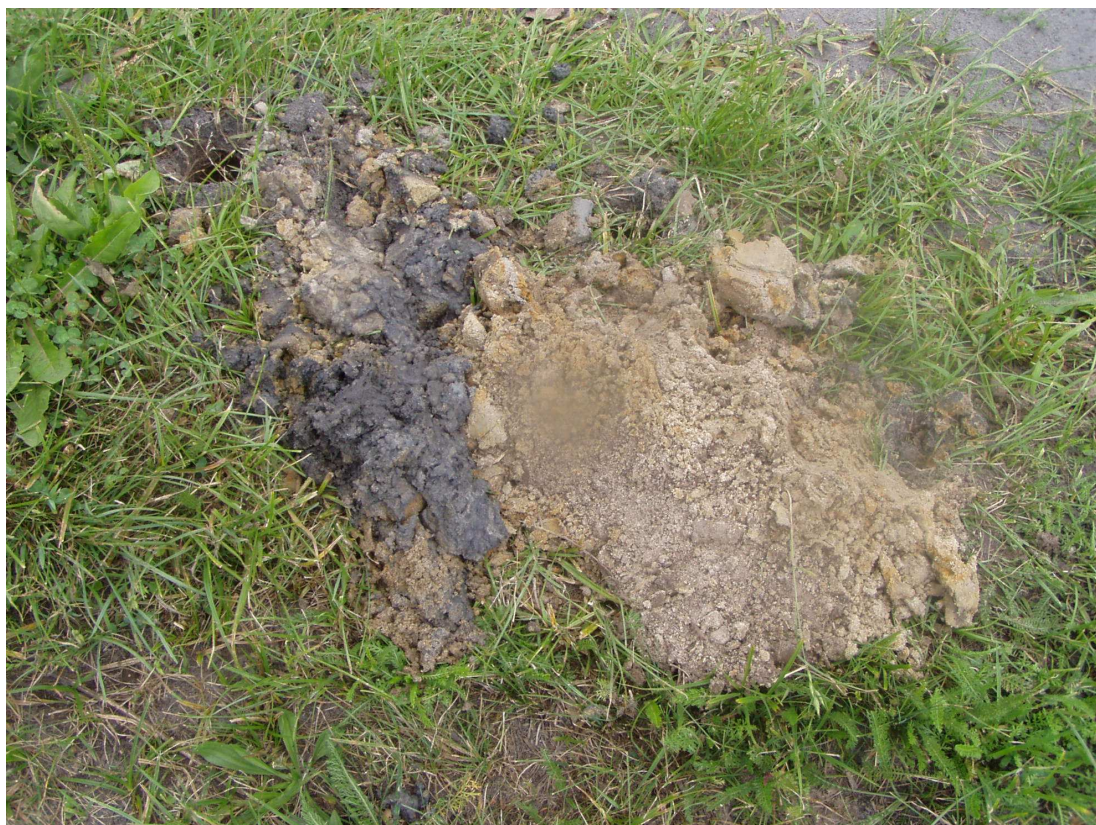
Wykonywanie odwiertów w poboczu 10cm darnina, 80cm piasek gliniasty, 40cm glina
